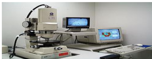
شکل ۲۵- دستگاه اینترفرومتر جهت بررسی لایه لیپیدی اشک
